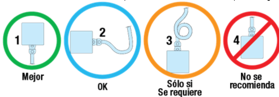
Figura 5.1: Trazado recomendado del cableado de ServoWeld.
